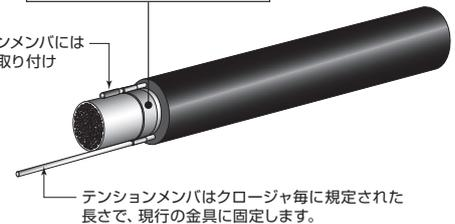
テンションメンバはクロージャ毎に規定された長さで、現行の金具に固定します。
