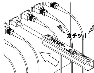
※アダプタに対して真直ぐに挿入してください。曲げ方向に力を加えると本体またはアダプタを破損させる恐れがあります。
