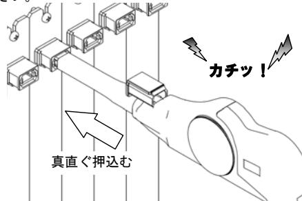
※アダプタに対して真直ぐに挿入してください。曲げ方向に力を加えると本体またはアダプタを破損させる恐れがあります。
