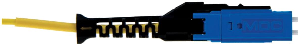
フジクラの ELiMENT™ MDC コネクタは、直径 2.0 mm までのマルチモードおよびシングルモードファイバケーブルの成端用に設計された超小型フォームファクタ (VSFF) デュプレックス光コネクタです。MDC コネクタは、業界標準の LC 光コネクタで使用されている実績のある 1.25 mm フェルール技術で製造されています。非常に高密度なコネクタ環境での個々のコネクタアクセスは、革新的な DirectConec™ プッシュプルブーツ技術を使用して簡単に実現できます。
