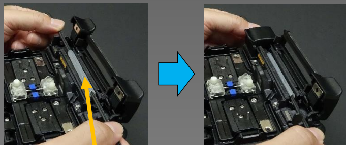
最大直径6mm まで加熱収縮可能
